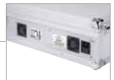
Integriertes Netzteil und aktiver Lüfter
