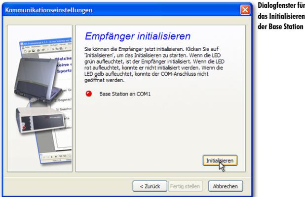
Zum Initialisieren der Base Station klicken Sie auf die Schaltfläche „Initialisieren“. Nachdem die Base Station richtig initialisiert ist, leuchtet im Dialogfenster die grüne LED auf. Anschließend klicken Sie auf „Fertig stellen“, um das Initialisieren der Base Station zu beenden.
