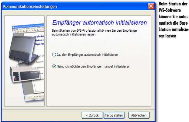
**Ja, den Empfänger automatisch initialisieren** Wenn Sie die IVS-Software starten, wird versucht, die Base Station an dem seriellen Anschluss und auf demselben Kanal zu initialisieren, auf den Sie die Base Station gerade eingestellt haben.
